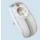
Adaptiergerät zum Schutz der Netzversorgung von elektronischen Geräten vor transienten Überspannungen sowie hochfrequenten Störspannungen (SF-Protector), mit optischer Funktionsanzeige (grün) und Defektanzeige (rot), Nennlaststrom 16A
